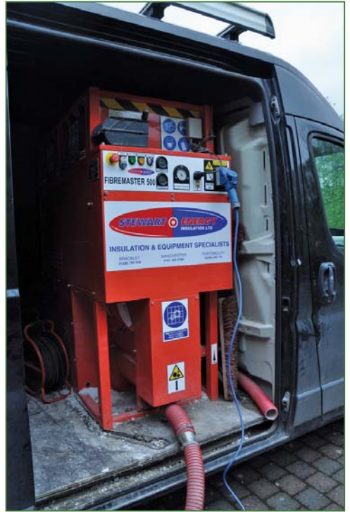
Foto links boven: Het opvullen van de boorgaten met mortel. Rechts boven: De inblaasmachine voor de glaswolvlokken. Onderaan: Glaswolvlokken als isolatiemateriaal.
